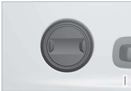
配备双向腰部支撑的车辆中的控制器*。
