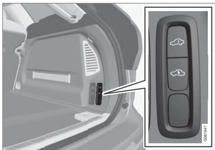
升高/降低车辆后部的控制器
