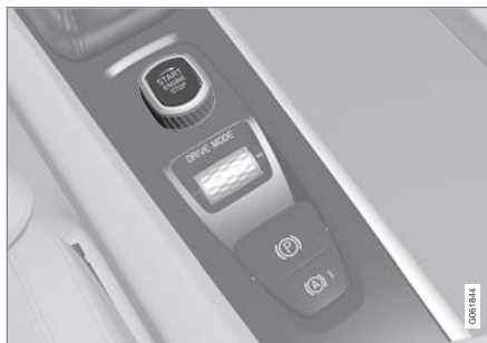
中央扶手控制台上的启动旋钮。
