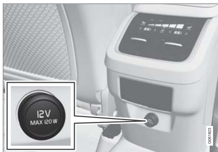
中央扶手控制台中的 12 伏电源插座，后排座椅。
