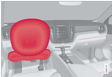
方向盘安全气囊与前排座椅驾驶员侧膝部安全气囊 1 。
