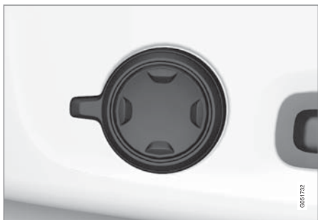
多功能控制器，位于座椅落座部分的侧部。
