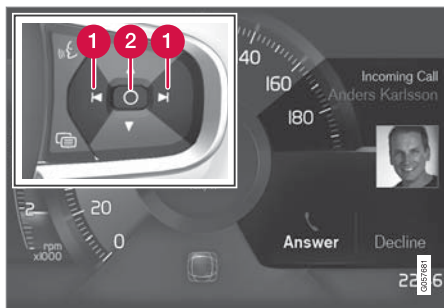
驾驶员显示屏 6 内的消息示例和方向盘右侧键盘。
