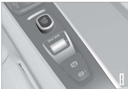
中央扶手控制台上的启动旋钮。
