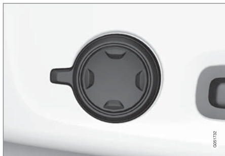
配备四向腰部支撑*的车辆中的多功能控制器。
