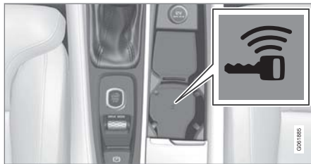
中央扶手控制台处的备用读取器。
