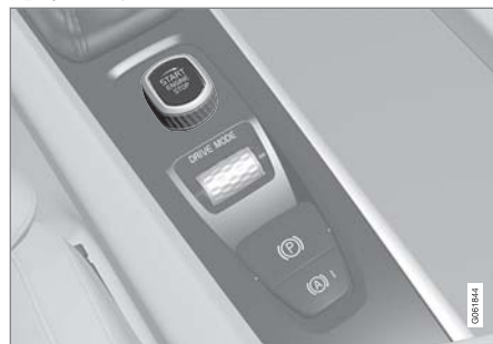
中央扶手控制台上的启动旋钮。
