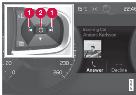
驾驶员显示屏 7 内的消息示例和方向盘右侧键盘。
