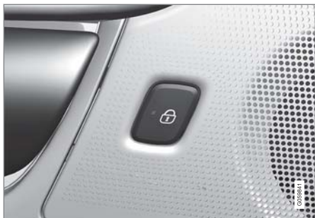
后车门处带指示灯的锁止按钮。
